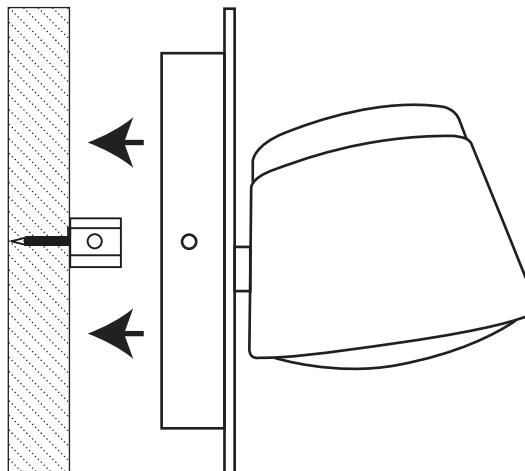
**ВНИМАНИЕ! Обязательно проверьте надежность крепления светильника к монтажной скобе!!!**
