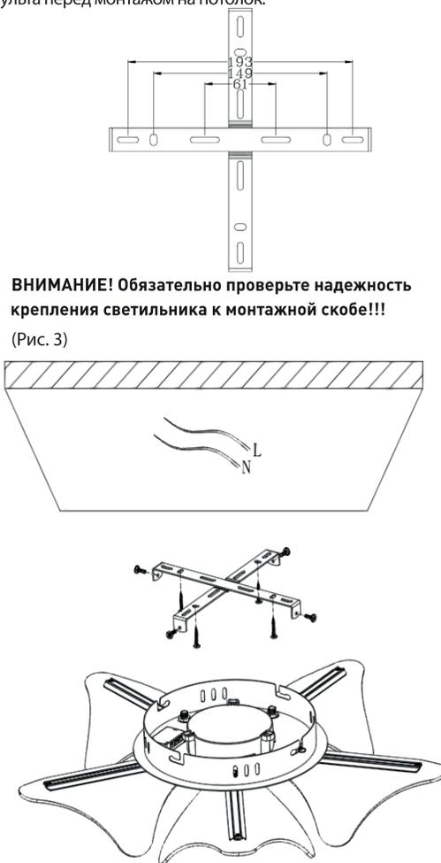
**ВНИМАНИЕ! Обязательно проверьте надежность крепления светильника к монтажной скобе!!!**
